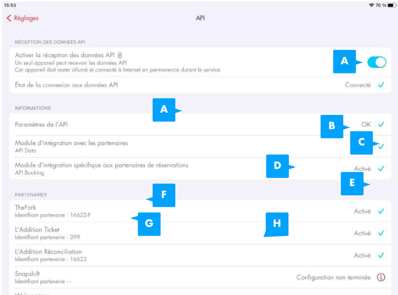
« **Activer la réception des données API ( A )** » : permet de connecter cet appareil uniquement au système ( websocket ) permettant de recevoir instantanément :
