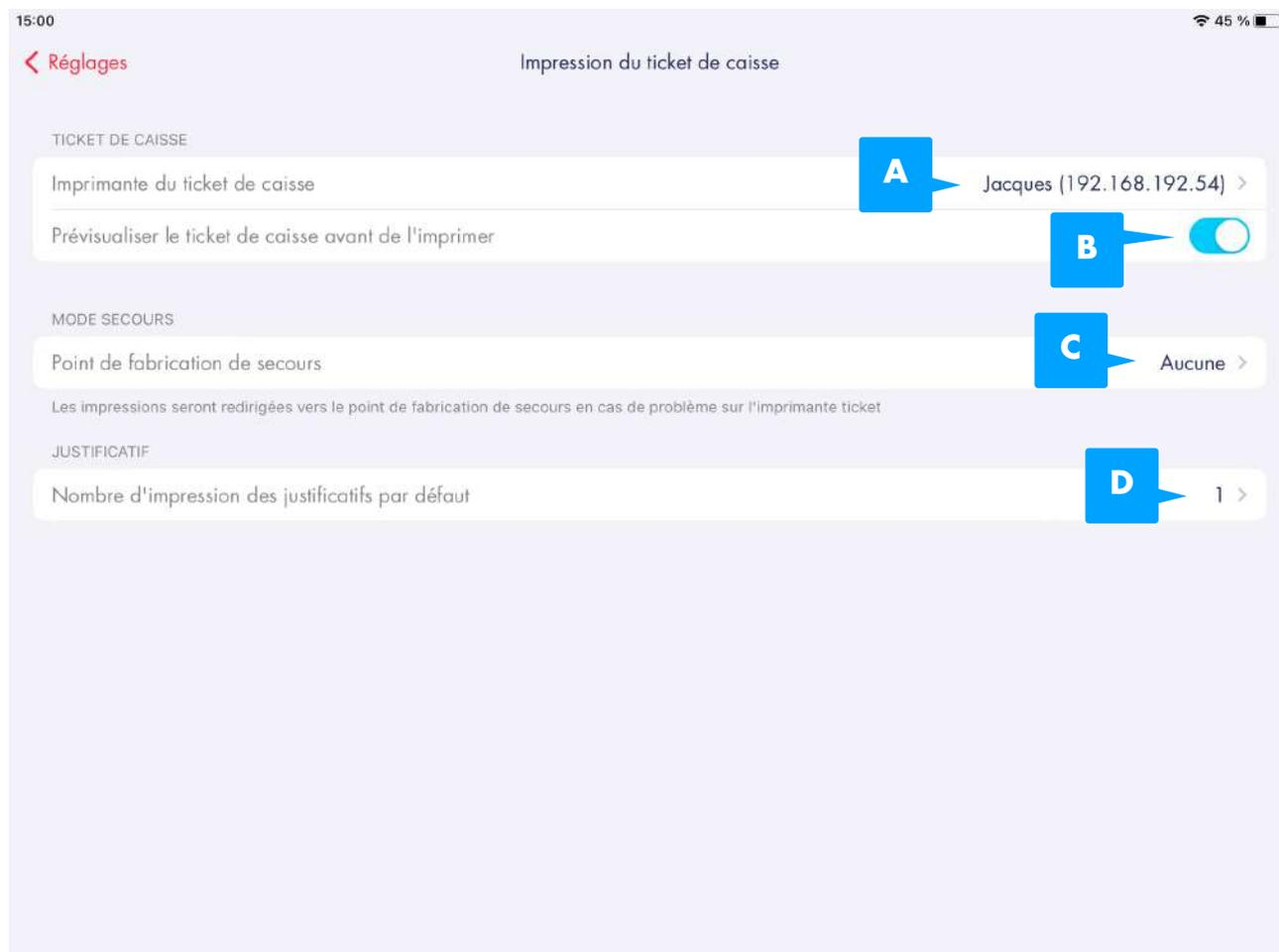
« **Imprimante du ticket de caisse ( A )** » : permet de définir sur quelle imprimante le ticket de caisse sera imprimé
