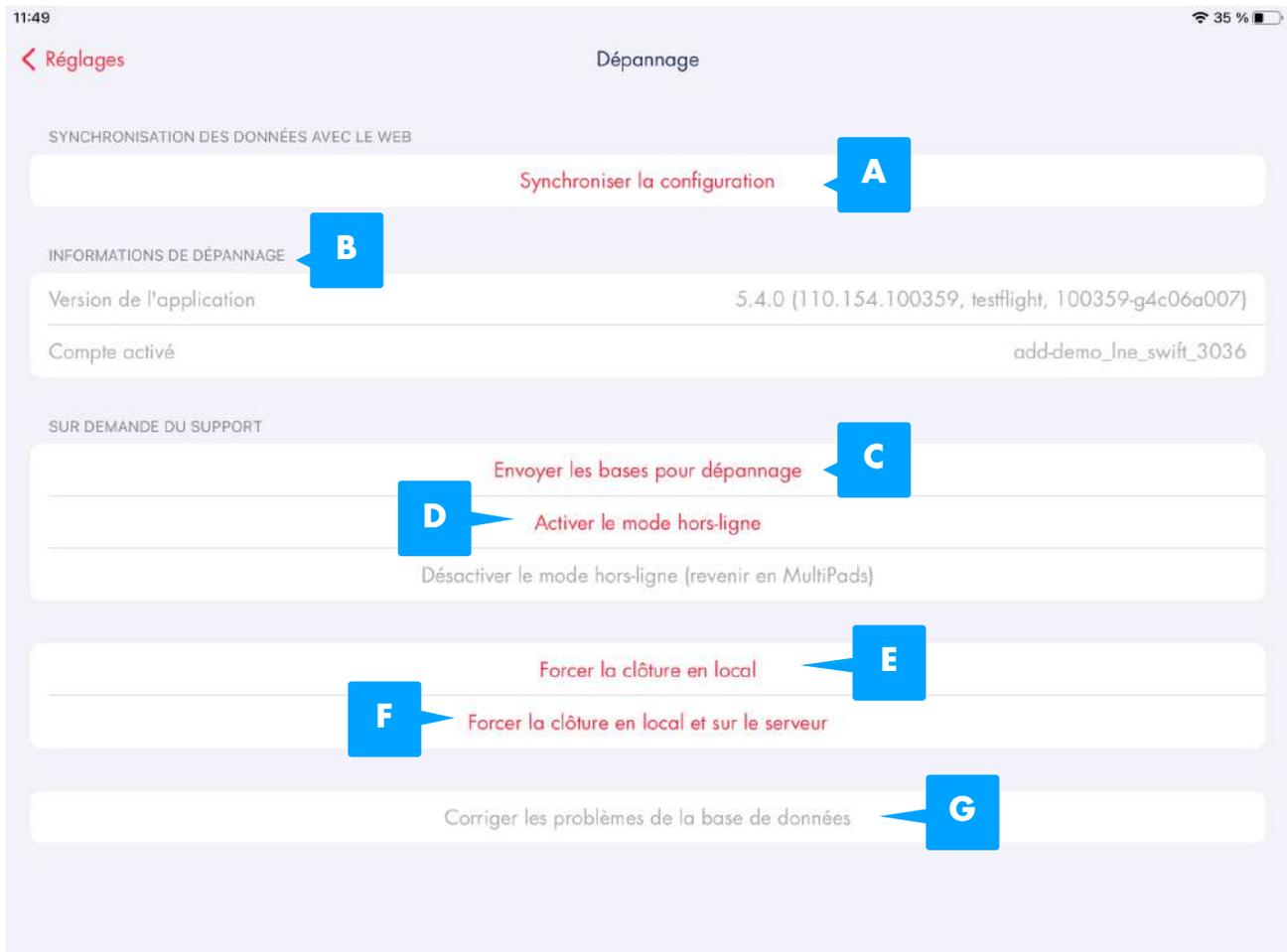
« **Synchronisation manuelle ( A )** » : permet d'effectuer une synchronisation le serveur web L'Addition ( sauvegarde de la configuration, options, carte et téléchargement des services en attente vers le reporting L'Addition ).
